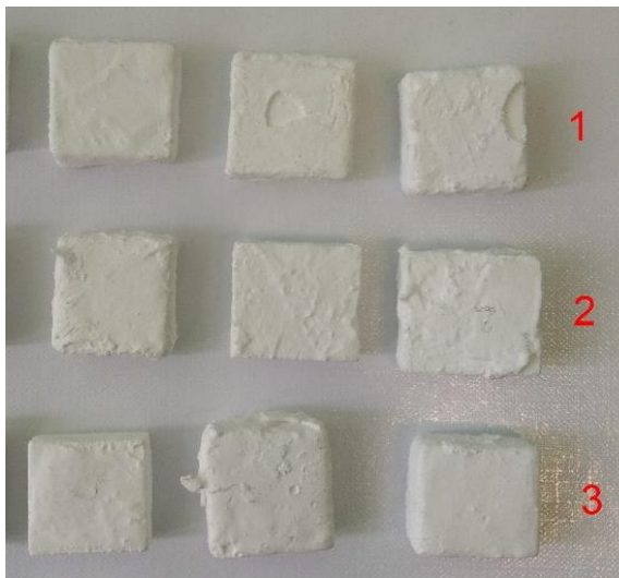
Wynik osadzania membrany z wykorzystanie metody zanurzeniowej
