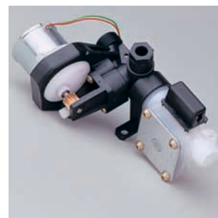
Komplette Sensoreinheit zur Durchflussmessung mit Volumenstromreduzierung in einem Elektro-Durchlauferhitzer. Werkstoffe: Polyamid, PPO, PVDF, Metall; Montage mittels Verrastung und Verschraubung
