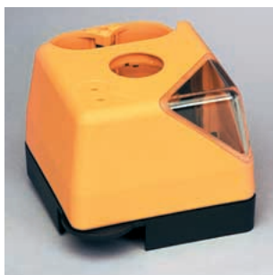
Steuergehäuse aus Polyamid mit eingespritztem Sichtfenster aus Polycarbonat für Laser-Nivelliergerät (Gewicht ca. 150 g); Verzug minimiert durch Material-Mix: Glasfaser-Glaskugel
