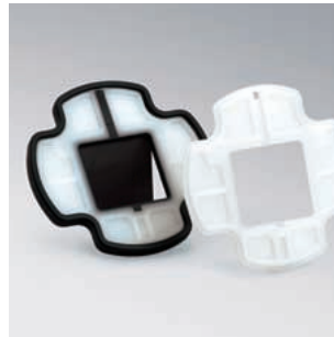
Komplette Gemischklappe für Gasbläsebrenner in Heizungsanlagen, bestehend aus 2-Komponenten-Grundplatte (Polyamid) mit Dichtung (TPE) montiert mit Außendichtung (Viton) und Schwingklappe (Polyamid mit 80% Kupferanteil)
