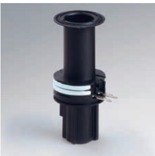
Spulenkörper aus glasfaser-verstärkten Kunststoffen (z. B. PA6) mit umspritzten CU-Kontakten und Stahljochen für den Einsatz in Nutzfahrzeugen
