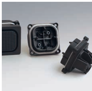
Taster für elektrisches Verriegelungssystem im Kraftfahrzeug bestehend aus Sockel mit geschäumter PU-Dichtung und montierter EPDM Dichtung sowie 2K-Tastelement (Rahmen und Tastelement aus Polyamid flexibel verbunden durch TPE)
